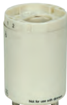
Smooth Phenolic 80-1846 120V, 60Hz, 0.15A 80-1852 277V, 60Hz, 0.15A 13W G24q-1 & GX24q-1 2" H x 1 1/2" W
